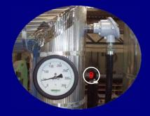
Coluna para colocação do material adsorvente isolada termicamente
