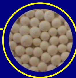
Determinadas aplicações de ar comprimido requerem um teor de umidade muito baixo (ponto de orvalho negativo entre -5 a -70°C aproximadamente), não sendo atendidos pelos sistemas de secagem por refrigeração (ponto de orvalho +3°C). Neste caso deveremos utilizar o secador que opera pelo princípio da adsorção.
